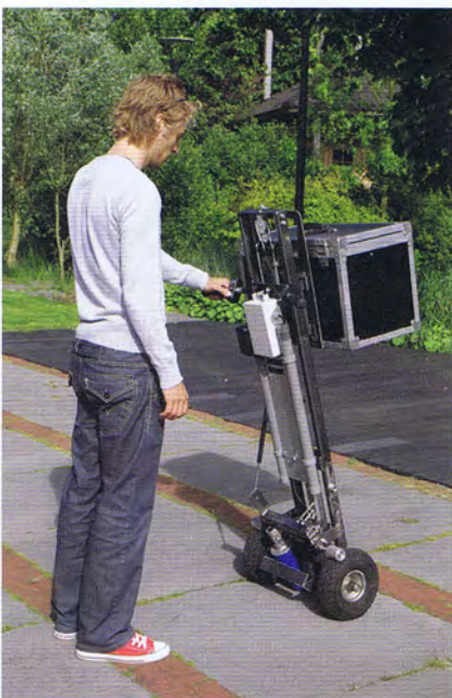
De Tiller tilt max. 75 kg tot 1,10 m. hoogte
