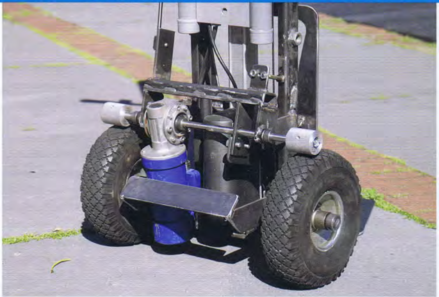
De rem met aandrijving zorgt voor de balans
